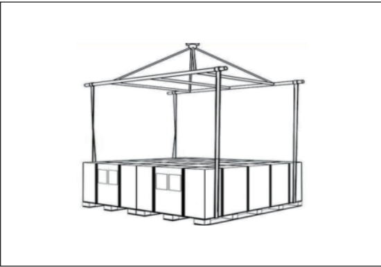
使用合理的吊装治具，吊装一次性最多允许2托组件。 品装前应确认托盘和纸箱是否有破损及品装的绳索是否 结实、牢固。吊装快着地时，两人一人一边扶正纸箱 轻轻放在项目地相对平坦的位置上。
